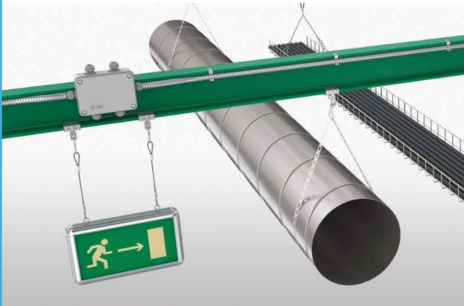
Балочные зажимы – это современная и безопасная система крепежа к балкам и металлоконструкциям, которая не требует проведения сварочных работ и трудоемкого сверления. Балочные зажимы забиваются на фланец балки при помощи обычного молотка, что значительно экономит время монтажа. В зависимости от толщины балки, необходимо использовать подходящие зажимы.
