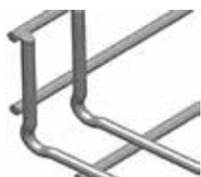
Формовка по основанию проволочного лотка и дополнительный поперечный пруток - отличительные особенности системы проволочных лотков МКТ, которые не только добавили эстетику во внешний вид, но и увеличили БРН (безопасную рабочую нагрузку) на 15%.
