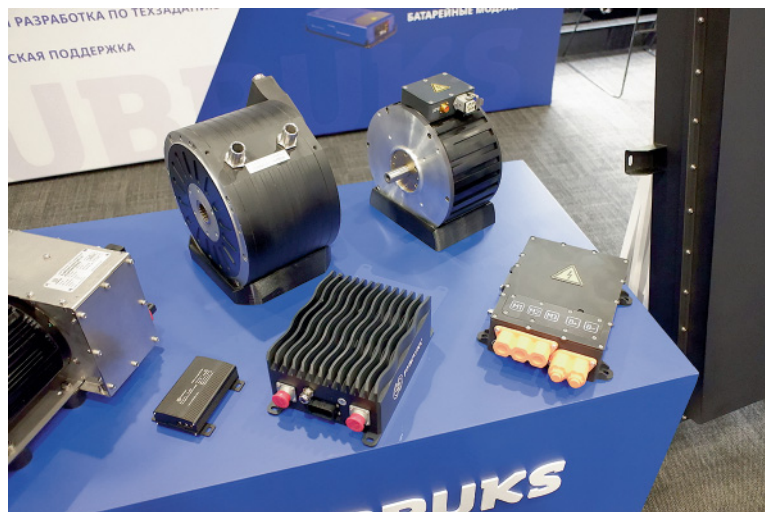
Двигатели, силовые устройства и модули управления для электротранспорта производства российской компании «РУБРУКС»
