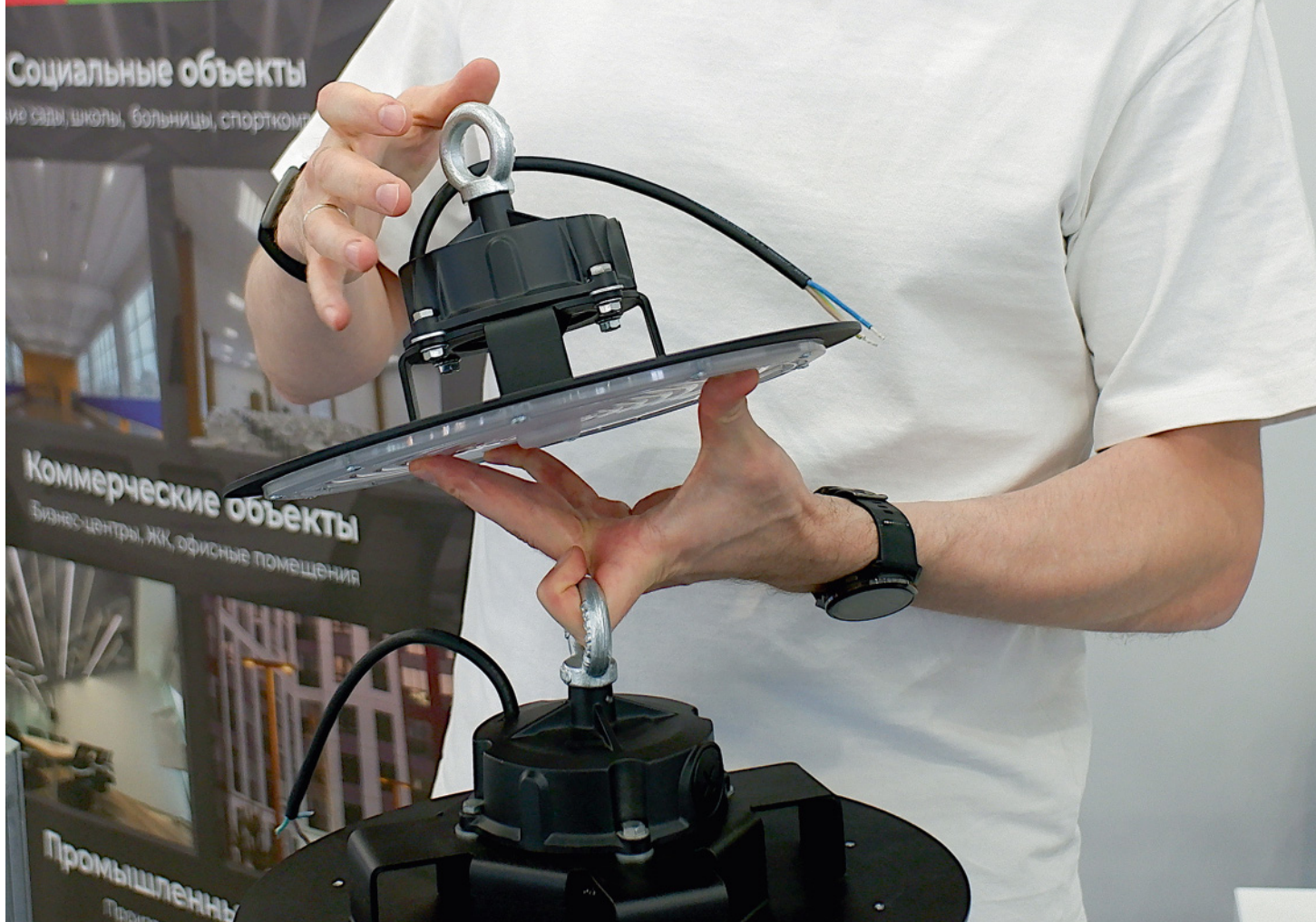
Между драйвером и светодиодами предусмотрен воздушный промежуток, защищающий драйвер от перегрева
