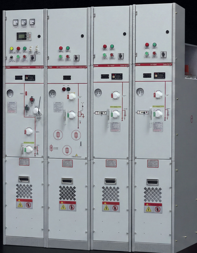
КРУ (ЭЛЕГАЗОВЫЙ МОНОБЛОК) до 35 кВ, In до 1250 А
